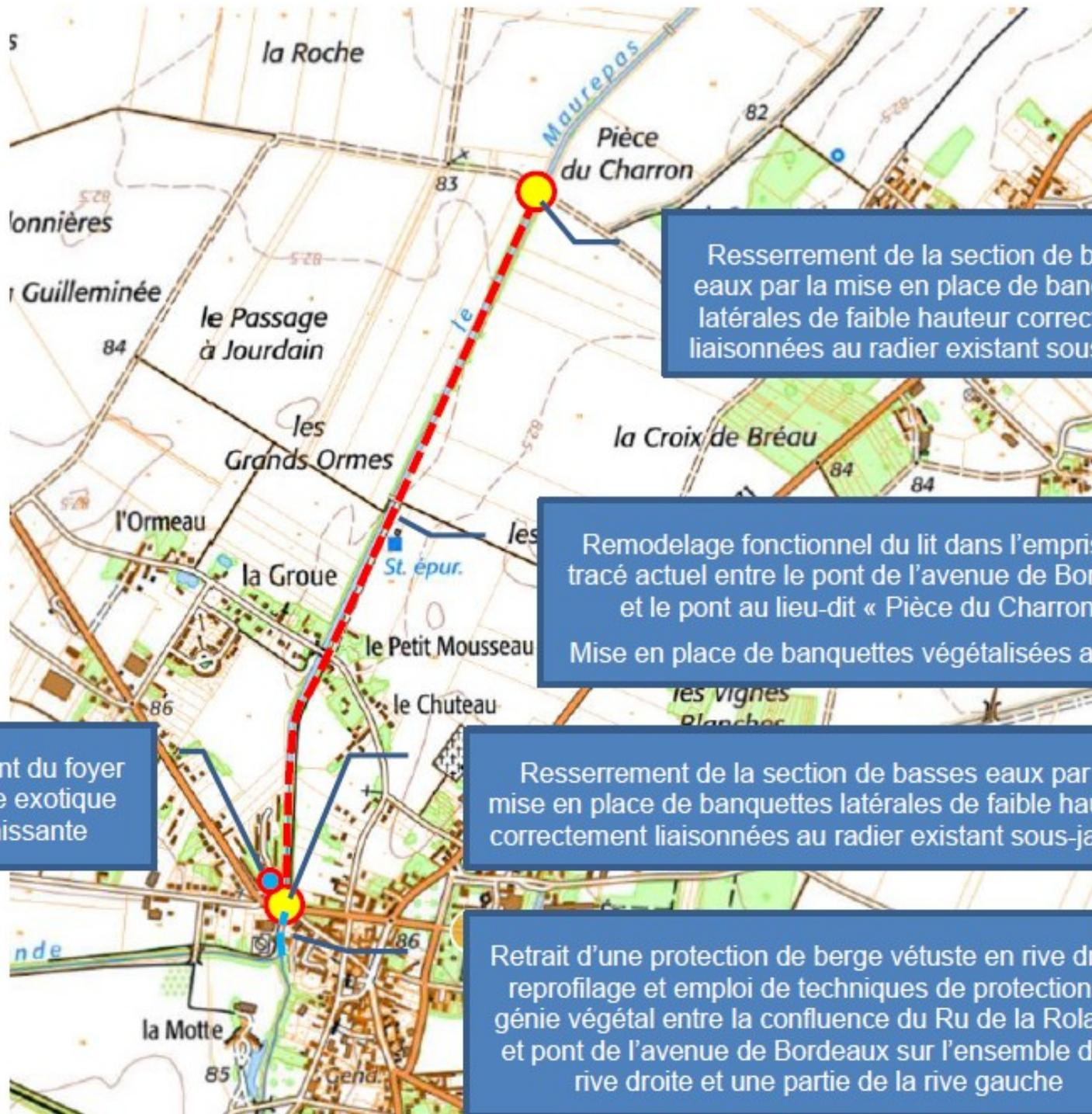
Resserrement de la section de basses eaux par la mise en place de banquettes latérales de faible hauteur correctement liaisonnées au radier existant sous-jacent
